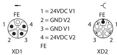
Fig. 27: Configuration des broches des connexions de tension d'alimentation, M12, 5 pôles
