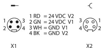
Fig. 25: Configuration des broches des connexions de tension d'alimentation, 7/8", 4 pôles
