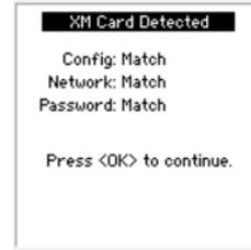
En outre, si les paramètres réseau ne correspondent pas (modèles XS/SC26-2de), les paramètres réseau du contrôleur de sécurité sont transférés à la carte SC-XM2/3. Une fois cette opération terminée, l'écran affiche ce qui suit :
