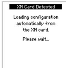
Après le chargement automatique, l'écran indique que la configuration a été reçue et qu'il faut effectuer une remise sous tension ou un reset système.
