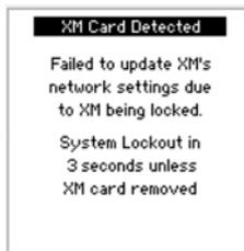
Si la carte SC-XM2/3 n'est pas retirée du contrôleur dans les 3 secondes, le contrôleur de sécurité se verrouille :
