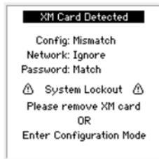
Illustration 271. Modèles XS/SC26-2de : verrouillage du système
