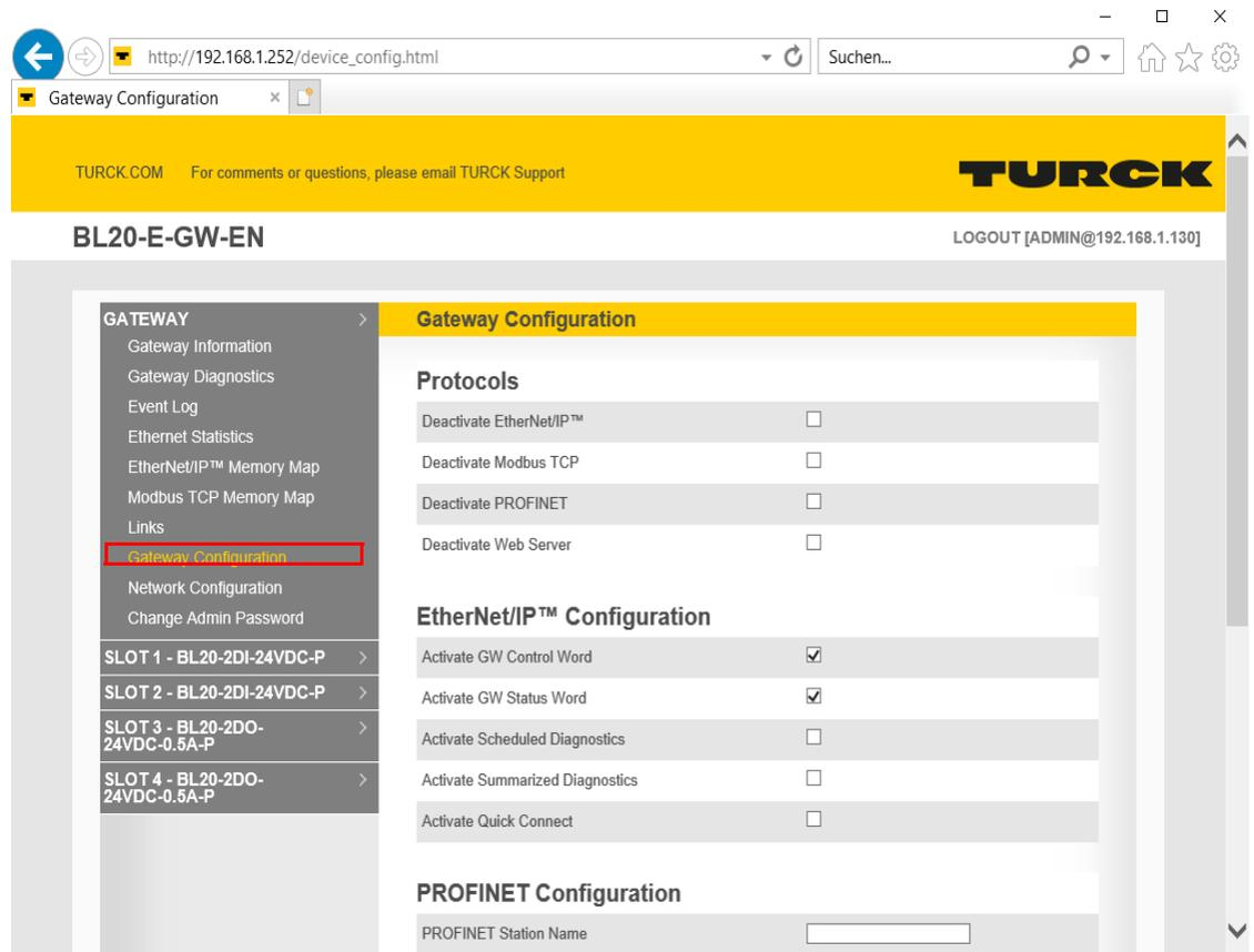
Fig. 22: Web server „Gateway Configuration“
