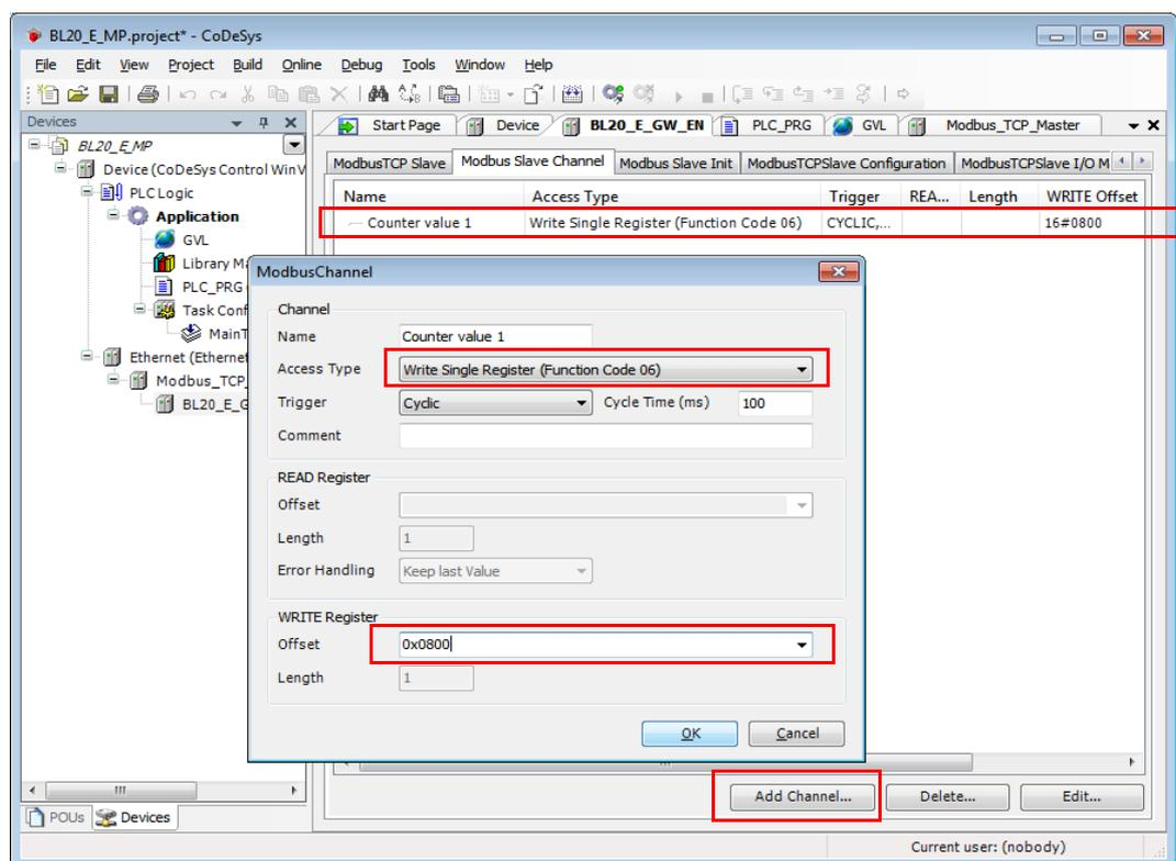
Fig. 67: Modbus channel, counter value, FC06
