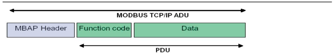
Fig. 46: Modbus telegram acc. to Modbus-IDA
