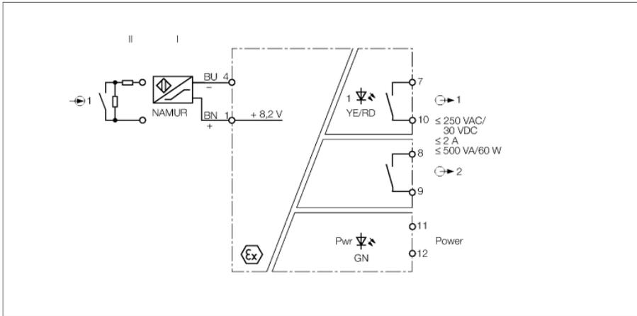
Der 1-kanalige Trennschaltverstärker vom Typ IM1-12EX-R ist mit einem eigensicheren Eingangskreis ausgestattet.
