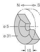
Ímán de activación; Ø 31 mm (Ø 5 mm), h: 15 mm; 90 mm de distancia de conmutación alcanzable en sensores de campo magnético BIM-(E)M12 o 78 mm en sensores de campo magnético BIM-EG08; para sensores de posición lineal Q25L: distancia recomendada entre el sensor y el imán: 3...5 mm
