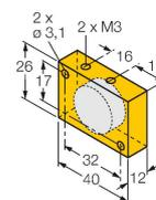
Actuador; plástico, rectangular; 58 mm de distancia de conmutación alcanzable en sensores de campo magnético BIM-(E)M12 o 49 mm en sensores de campo magnético BIM-EG08; para sensores de posición lineal Q25L: distancia recomendada entre el sensor y el imán: 3...5 mm
