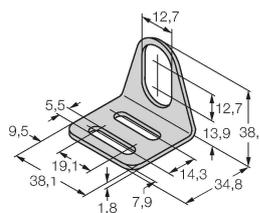
Soporte de montaje para sensores de tubo roscado; material: acero inoxidable A2 1.4301 AISI 304)
