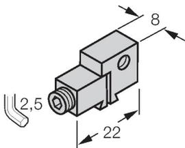
Soporte de montaje para el montaje de sensores de campo magnético en cilindros de ranura en cola de milano
