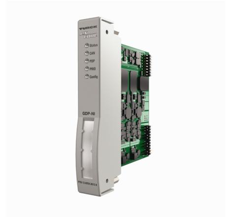
El gateway GDP-NI sirve para conectar el sistema *excom*® a redes PROFIBUS-DP. Para conectar al PROFIBUS-DP pueden emplearse bien cables de fibra óptica o bien cables de cobre. Con los cables de fibra óptica es necesario, para permitir el intercambio de datos, instalar un par acoplador LWL entre el PROFIBUS alámbrico y el óptico.
