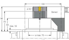
Jeu de montage pour détecteurs doubles pour actionneurs d'électrovannes plus grands ; Ø rondelle et anneau élastique : max. 110 mm ; configuration des trous sur face à flasque : 30 × 130 mm ; hauteur de l'arbre de raccordement (pivot) : 50 mm / Ø : max. 75 mm
