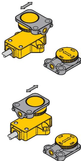
La meilleure flexibilité lors du montage est réalisée, de par le fait que le transmetteur de position peut être fixé suivant un angle de décalage de 90°.
