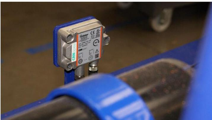
Dans la version industrielle des capteurs d'inclinaison de Kübler, la précision du capteur est augmentée par l'amortissement de l'élément à l'intérieur du capteur. Cela rend également le capteur plus résistant aux chocs. L'IN88 atteint une précision de +/- 0,2° tout en résistant à des chocs allant jusqu'à 100g. Tout cela et un haut degré de protection jusqu'à IP69k font de ce capteur l'outil idéal pour les applications mobiles.
